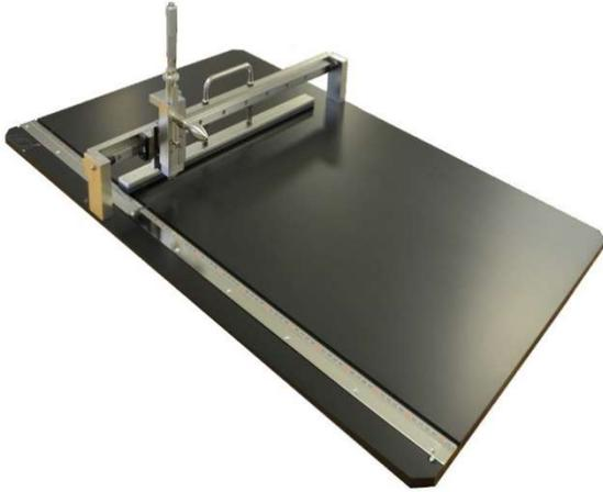
Der MDI Linearschneider LC500 ist ein nützliches Gerät für manuelle gerade Schnitte, nicht nur einsetzbar für eine Vielzahl an Glasorten, auch andere spröde Materialien können separiert werden. Der Linearschneider kann mit verschiedenen MDI Schneidwerkzeugen ausgestattet werden.
