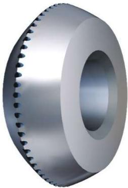
Aufgrund seiner patentierten Zahnung entlang des Grates erreicht das Penett® Rädchen eine mediale Ritztiefe von bis zu 90% der Glasdicke. Hierdurch wird der Brechprozess erheblich vereinfacht, im besten Falle sogar überflüssig.
